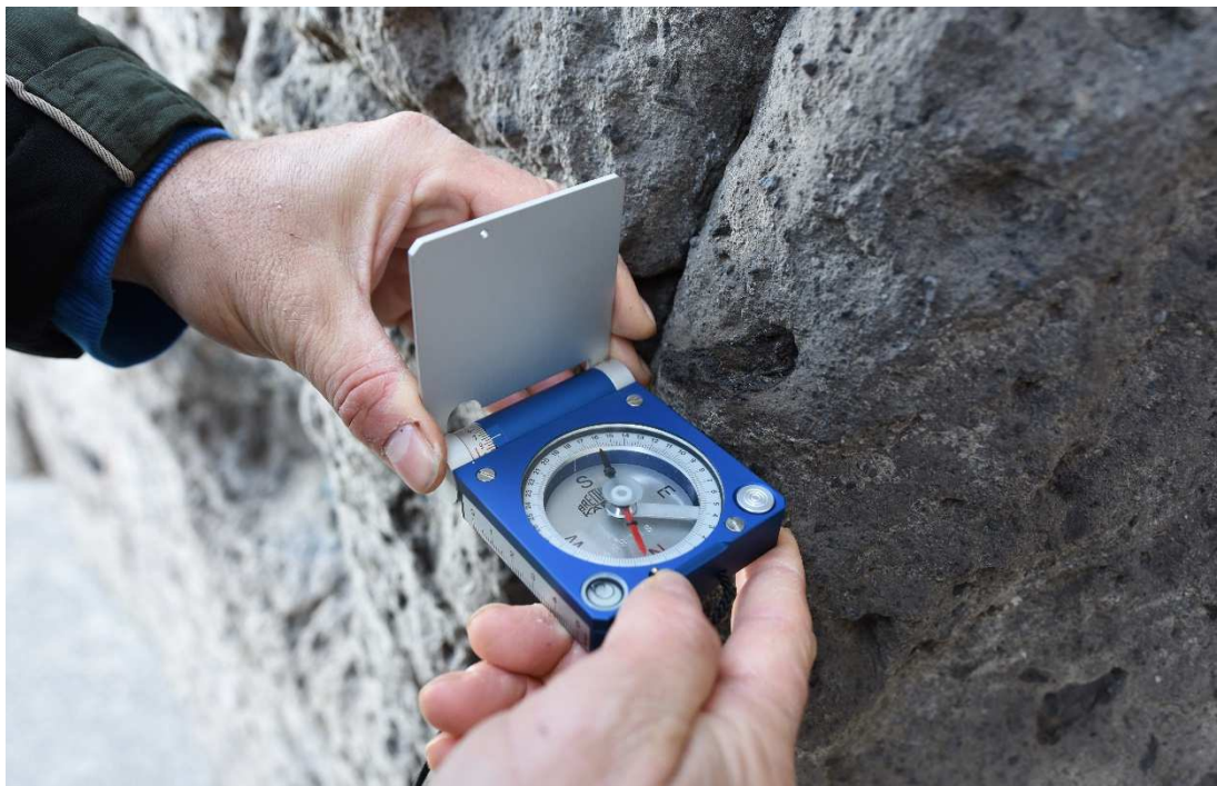
Foto n. 10: Determinazione di una giacitura con la bussola di Clar.
