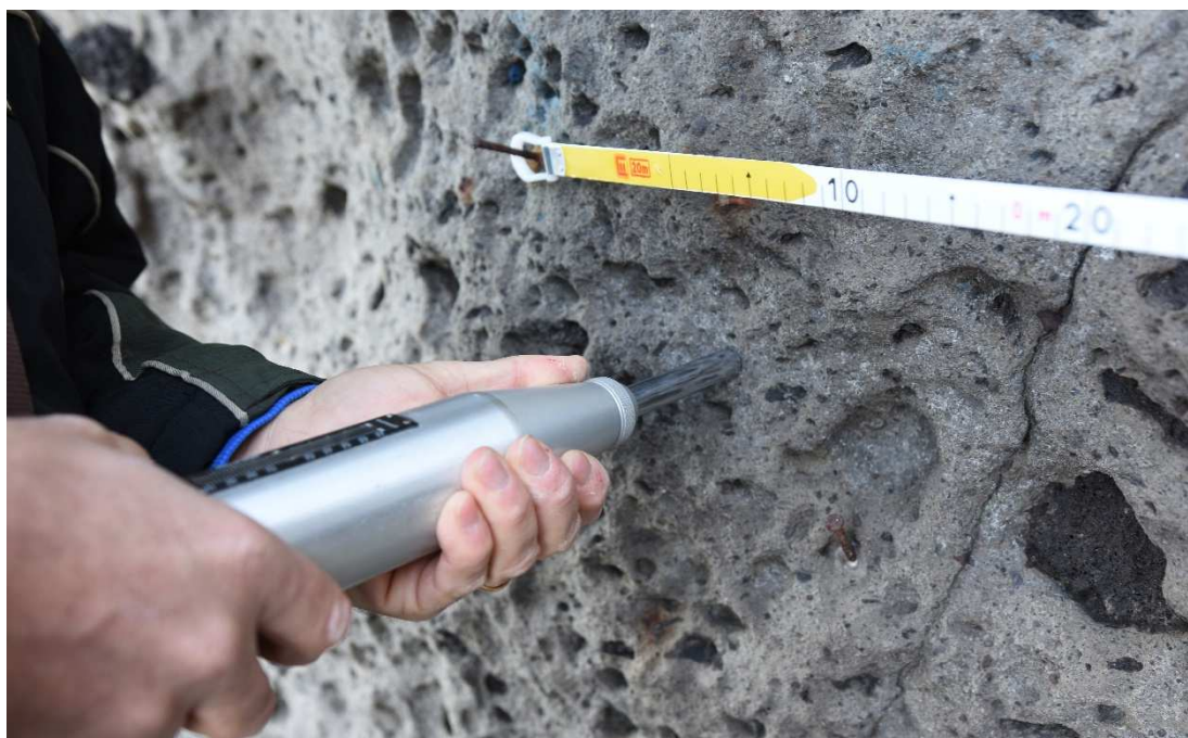
Foto n. 12: Determinazione della resistenza a compressione uniaassiale con il martello di Schmidt (sclerometro per rocce).
