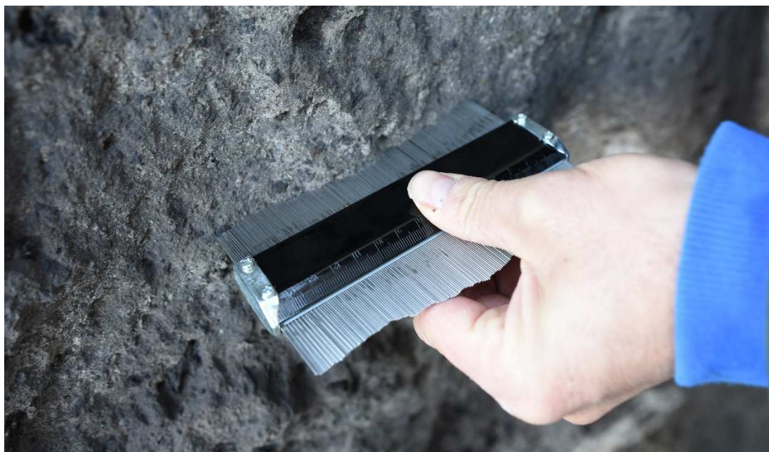
Foto n. 11: Determinazione del profilo di rugosità con il pettine di Barton.
