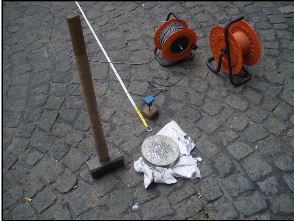
Fig. 15 – Sorgente energizzante, costituita da massa battente su piastra di alluminio. Come starter/trigger è stato utilizzato un geofono verticale Geospace a 14Hz.
