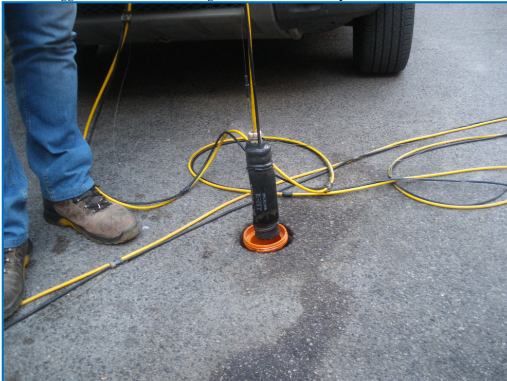
Fig. 11 – Sonda geofonica da foro a tre componenti (3 geofoni Geospace a 4.5Hz).
