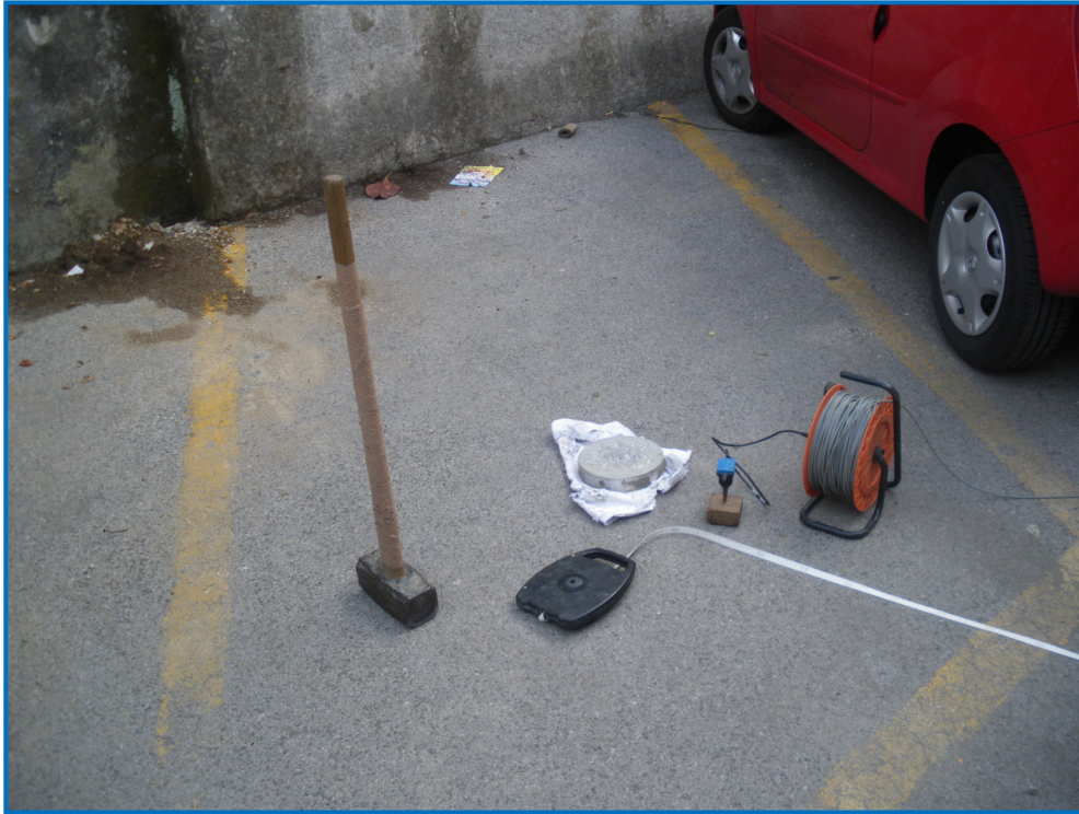
Fig. 10 – Sorgente energizzate, costituita da massa battente su piastra di alluminio. Come starter/trigger è stato utilizzato un geofono verticale Geospace a 14Hz.
